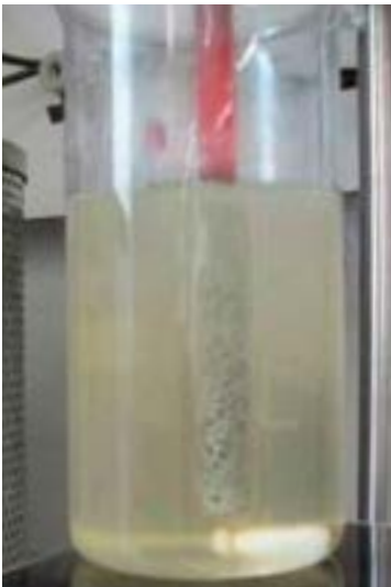
Рисунок 5: Разрушение паровой фазы закалочной жидкости на основе PVP
