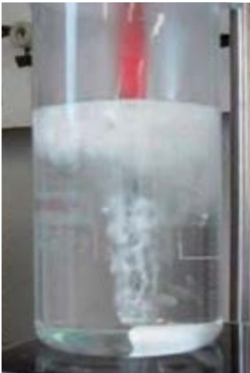
Рисунок 4: Разрушение паровой пленки в водном растворе PAG (концентрация > 20%)
